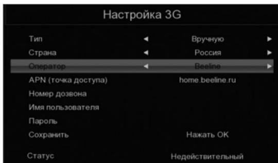
Для выхода в интернет вам необходимо подключить совместимый 3G-модем (см. список ниже) в USB-порт, подтвердить лицензию, следуя инструкции на экране, и перейти к настройкам подключения нажатием опции «Подключить».
